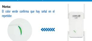
Si el indicador no está de color verde, restablezca el repetidor a su configuración de fábrica.
